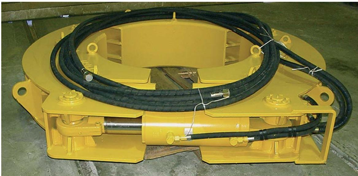
Die hydraulische Abfangschelle Typ SPA kommt auf Baumaßnahmen zum Einsatz, wo Bohrpfähle im Drehbohrverfahren hergestellt werden. Die hydraulische Abfangschelle Typ SPA garantiert ein sicheres Halten der Rohrtour beim Rohrrückzug.
